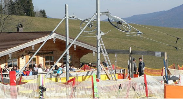
Multi Vertikallift 2,2 kW Antriebsstation Multi Verticallift 2,2 kW / 3 hp drive station
